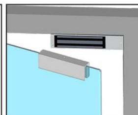
Instalación del montaje en "U"
